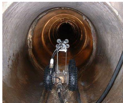
រូបភាព ១៨. ប្រព័ន្ធការម៉ោងចល័តប្រើប្រាស់សម្រាប់ប្រភេទលូមុខកាត់តូច (Source: EPA, 2003) និងការធ្វើតេស្តបណ្តាញលូខ្លាំងរងដោយប្រើការម៉ោងទូរទស្សន៍
